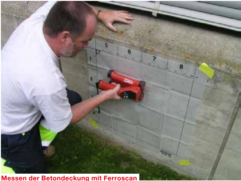
Messen der Betondeckung mit Ferroskan
