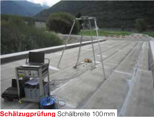
Schälzugprüfung Schälbreite 100mm
