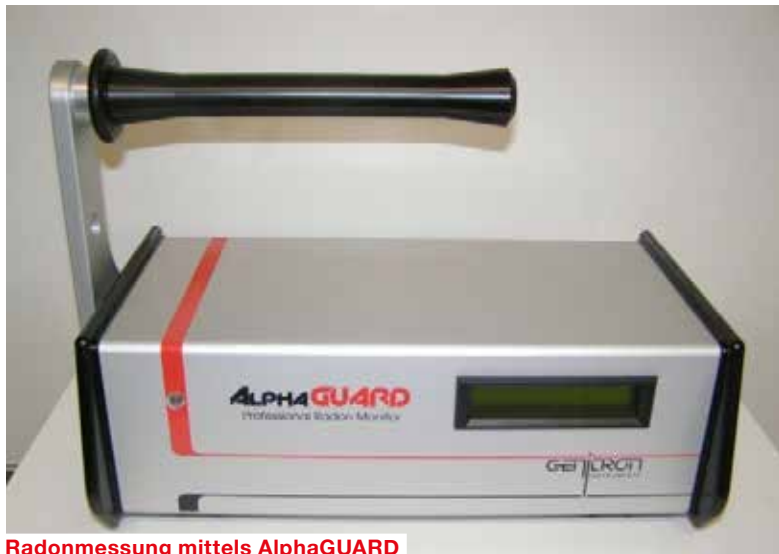
Radonmessung mittels AlphaGUARD
