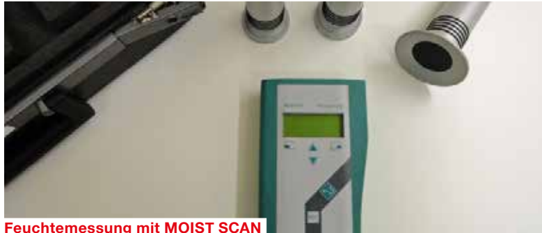
Feuchtemessung mit MOIST SCAN
