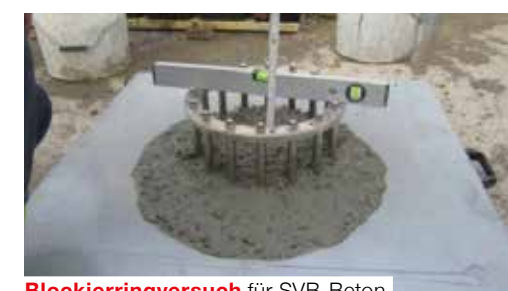
Blockierringversuch für SVB-Beton
