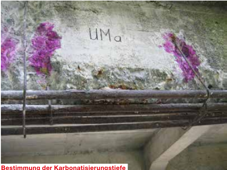
Bestimmung der Karbonatisierungstiefe
