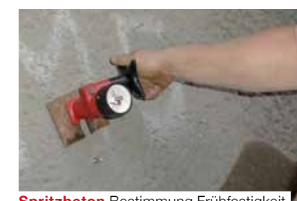
Spritzbeton Bestimmung Frühfestigkeit
