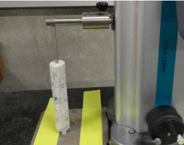
Sulfatwiderstand Prüfungsdauer: ca. 3 Monate
