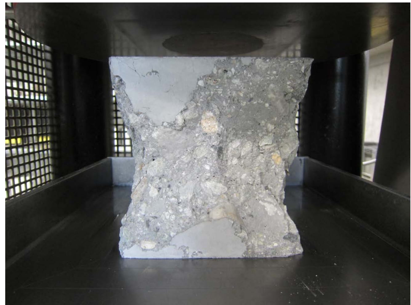
Zufriedenstellendes Bruchbild eines Betonwürfels
