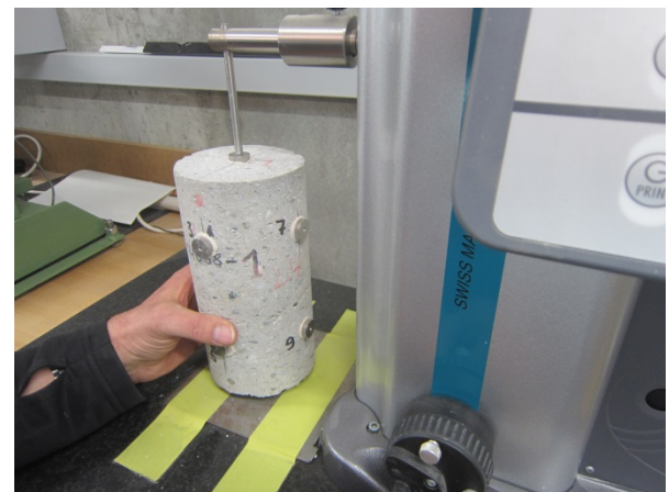
Abb. 2-8 Abstichmessung am Bohrkern
