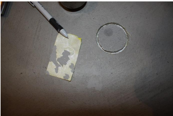
Abb. 4-4 abgezogenes Klebeband auf der Versiegelung
