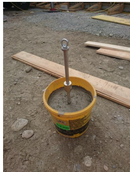
Abb. 2-7 Einsatz der Betonsonde nach Humm
