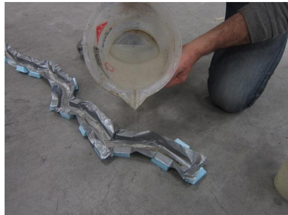
Abb. 2-8 Vergiessen eines Trennrisses mit einem niedrigviskosen Epoxidharz
