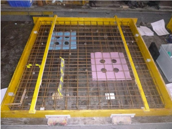
Abb. 8 Prüfkörper vor dem Betonieren mit den eingelegten (hellblau und pink) Dämmplatten.
