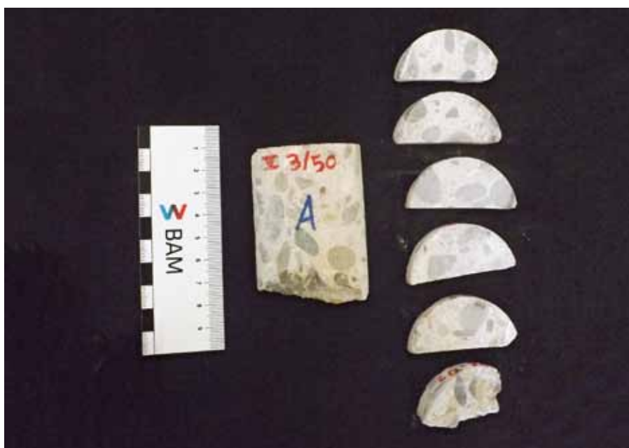
Abb. 2/3: Die nasschemische Analyse ist aufwendig. Zunächst werden Bohrkern entnommen und dann in mindestens drei jeweils zehn Millimeter dicke Scheiben gesägt. Diese werden einzeln zermahlen und analysiert.
