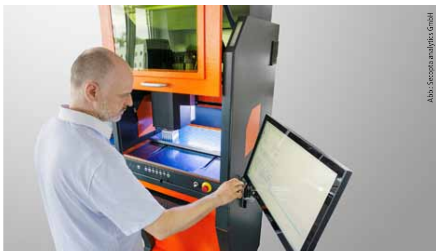
Abb. 4: In so einer automatisierten Messkammer kann eine schnelle orts aufgelöste LIBS-Messung durchgeführt werden.
