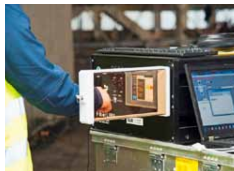
Abb. 7–10: Mit dem Prototyp des mobilen LIBS-Systems lässt sich die ortsaufgelöste Elementverteilung von Chlorid bestimmen.
